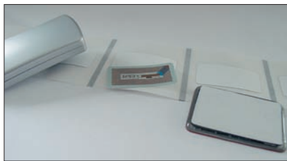
Screen fid: RFID Lese-/Schreibgerät und Transponder: Paper Label und Tag OnMetal.
